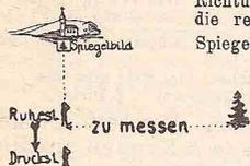
Nun wird das Bajonett mit der daran befestigten Schnur zwischen den Füßen des Messenden in den Boden gesteckt, die Schnur nach rückwärts in der Direktion Kirche abgewickelt, bis die Schnurlänge (Basis) beiläufig der geschätzten Distanz entspricht; d. i. 1:50, bzw. 1:100 der geschätzten Distanz.
